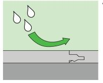
• Покрытие обладает влагостойкостью в условиях относительно стабильной влажности. Любой ламинат можно протирать тряпкой, используя специальные жидкости. Водостойкий ламинат имеет замки, обработанные воском или водостойкой смолой, нижний слой панели дополнительно обработан влагостойкой смолой.
