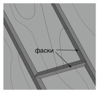
• Некоторые модели ламината имеют фаску — скошенный край доски. Фаска может быть двухсторонняя длинным сторонам панели) или четырехсторонняя. Ее глубина также может быть различной: V-образная имеет глубину 2 микрофаска — всего 1 мм. Ламинат с фаской подходит для помещений с высокой проходимостью. Стык между двумя досками — самое «спабое место» напольного
